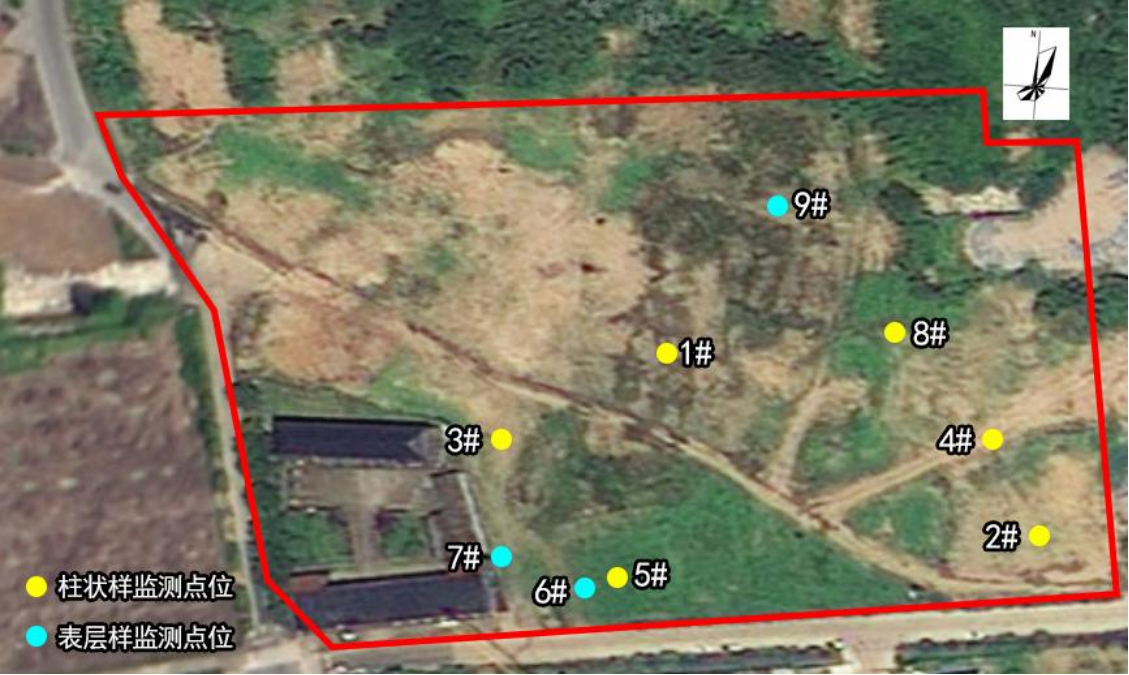
图 5.3-4 本项目拟建厂区内土壤监测点位图
